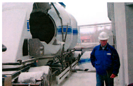
Alvarleg slys hafa orðið þegar verksmiðjuloft með fullum þrýstingi hefur verið notað til þess að auka afkastagetu loftsins t. d. þar sem losunarlagnir eru langar. Of hár þrýstingur, 5 bör, hefur farið öfuga leið inn í þrýstítankinn.
